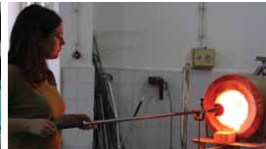
Resim 5,6,7: Kırmızı renkli cam çubukların pipo ucuna yapıştırılıp ısıtılması ve ilk cam kürenin oluşturulması.
