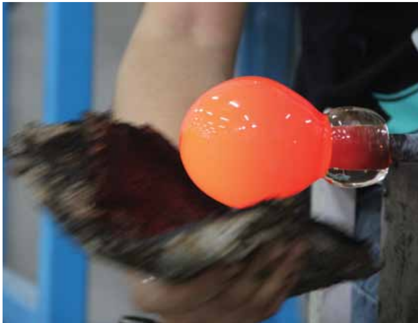
Resim 5,6,7: Kırmızı renkli cam çubukların pipo ucuna yapıştırılıp ısıtılması ve ilk cam kürenin oluşturulması.
