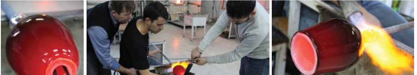
Resim 17,18, 19: İki renk katmanlı vazonu ağız kısmının açılması, bitmiş formun soğutma fırınına konması. Picture 17, 18, 19: Opening of the mouth part of the two colored layered glass; placement of finished form in the cooling kiln
