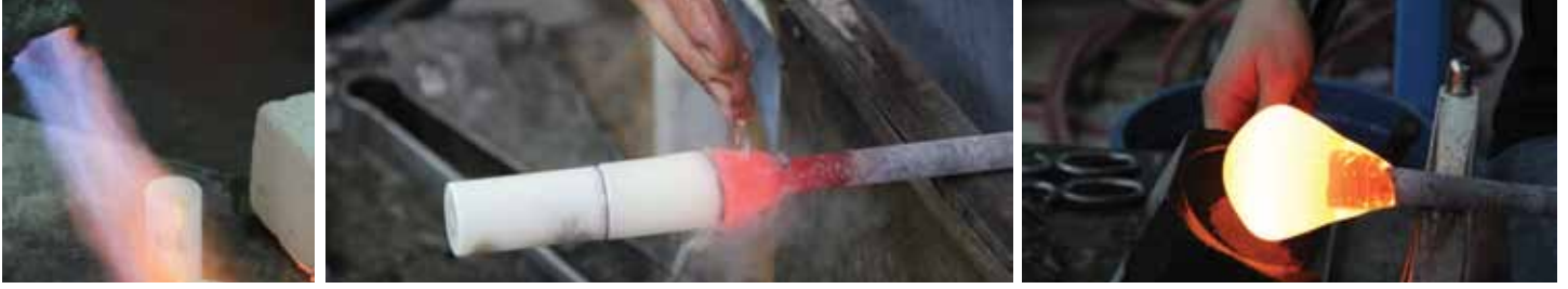
Resim 8,9,10: Beyaz renkli cam çubukların pipo ucuna yapıştırılıp ısıtılması ve ikinci cam kürenin oluşturulması. Picture 8, 9, 10: Heating of white colored glass bars by adhering to tip of pipe of and formation of the second glass bubble
