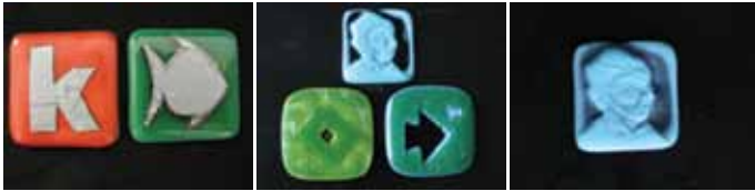
Resim 27, 28, 29: Çok renkli cameo örnek cam plakaları: Kumlama yapılmak üzere folyo ile kapatılmış ve kumlama yapılmış iki ve üç renk katmanları ile oluşturulmuş 5x5 cm örneklerden görüntüler. Picture 27, 28, 29: Multi-color cameo specimen glass plates: Views of 5x5 cm specimens formed using two and three color layers that were covered with foil and then sanded
