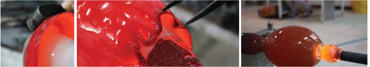
Resim 14,15,16: Kırmızı camın beyaz cam üzerine sıvanarak giydirilmesi, çelik çubuğun ucuna alınması. Picture 14, 15, 16: Cladding of red glass onto white glass by smearing and its being taken to the tip of the steel rod.
