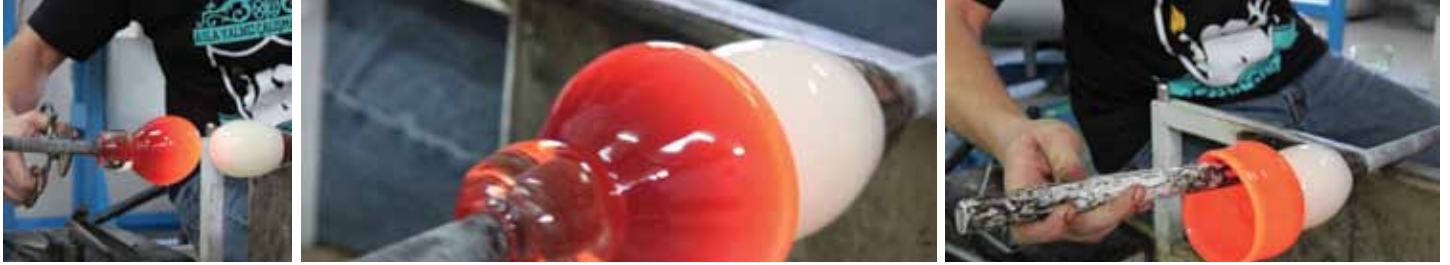
Resim 11,12,13: Kırmızı cam kürenin açıldıktan sonra beyaz cam kürenin üzerine tersten giydirilmesi. Picture 11, 12, 13: Cladding of the red glass bubble after opening from reverse over the white glass bubble
