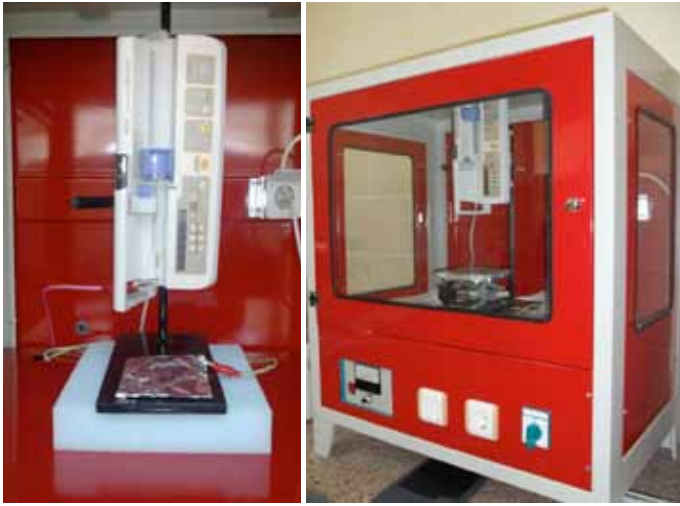
Şekil 2. Elektroğirme deney düzeneyi
