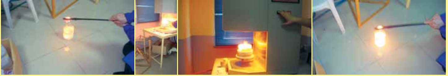
Şekil 1. Biyocam tozunun eritilmesi ve sulanması Fig. 1. Bioglass powder melting and quenching
