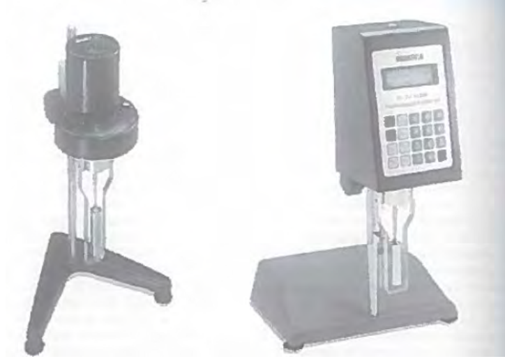
Şekil 3.21 – Biri analog ve diğeri dijital göstereye sahip iki farklı Brookfield viskozimetresi modeli.
