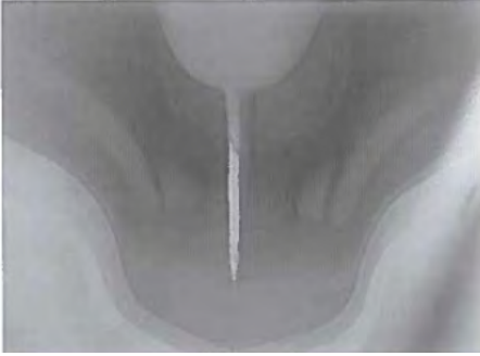
Şekil. 1.9 – İnce bir kalınlığa sahip çekirdek dökümlü bir klozetin kesit resmi
