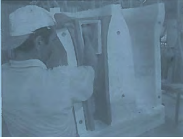
Şekil 1.47 – Mekanik dökümde ayakların kalıptan çıkarılması
