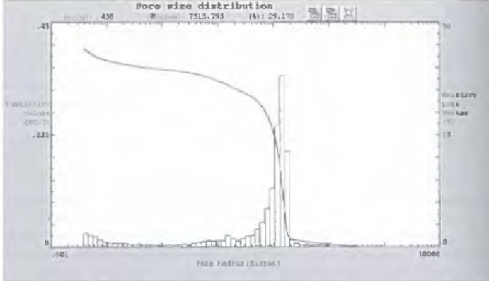
Şekil 2.37 – Bir reçine kalıp malzemesi içerisindeki, civalı porozimetre ile ölçülen gözenek boyutu dağılımı eğrisi
