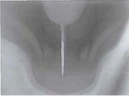
Şekil 1.10 –Boyutu küçülen çekirdek dökümlü bir alanda çatlak oluşumları
