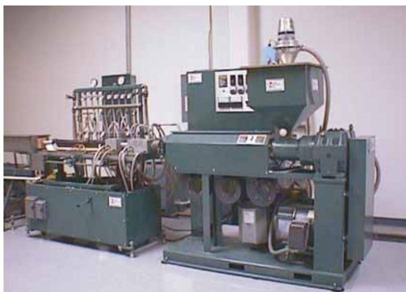
Şekil 9. Plastik ekstrüzyon makinesi [14]
