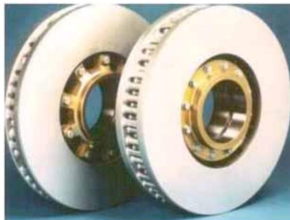
Şekil 1-a. AlSi7Mg bazlı SiC partikül takviyeli kompozit malzemeden üretilmiş bir hızlı tren fren diskı (1)
