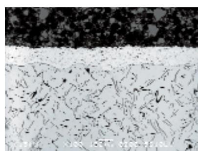
Şekil 8 d: Gri Dökme Demir ve Kaplama Mikroyapısı
