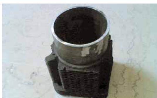
Şekil 8 a: Diesel Silindir Gömleği
