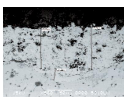
Şekil 8 f: Kaplama Mikroyapısı (arabağlayıcılı)
